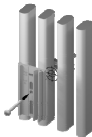
Figura 4. Instalación del repartidor de costes de calefacción en elemento de radiador.
