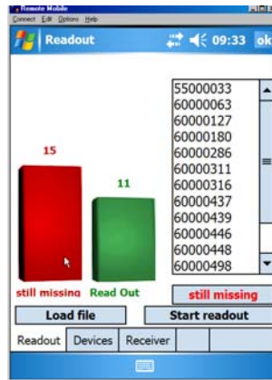
Figura 5. Ejemplo pantalla lectura repartidores de costes de calefacción.
